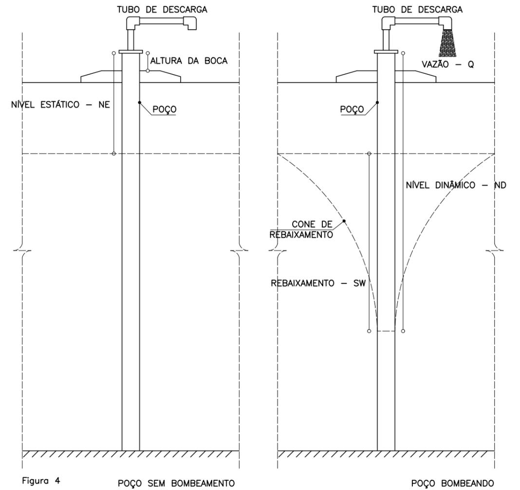
Figura 4 POÇO SEM BOMBEAMENTO
